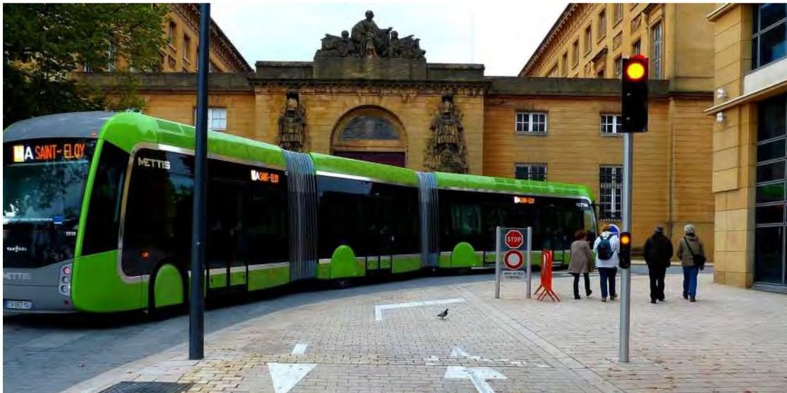
Quelle: komobile (Anmerkung: Abschnitt mit enger Kurve; Begegnungsfall Bus – Bus ist angesichts der Schleppkurve nicht möglich, daher einspuriger signalgeregelter Abschnitt am Ende des place de la République.)
