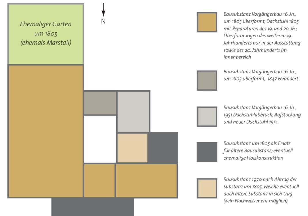
Einfaches Schema der Baukörper und ihrer Substanz vor Beginn der Arbeiten
