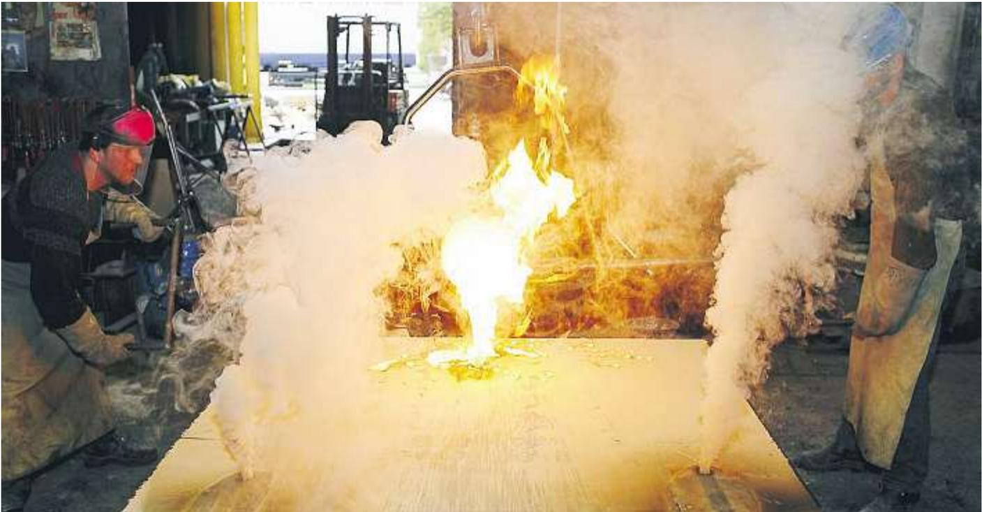
Die flüssige Bronze wird in den Formenkasten eingegossen
