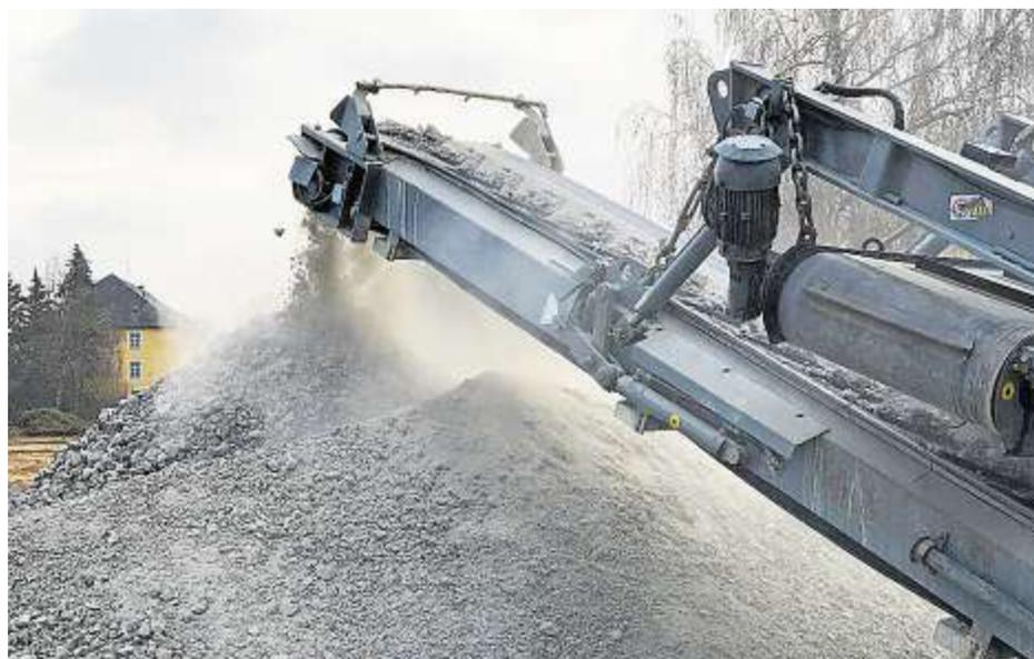
→ Das Material wird immer weiter zerkleinert und von Fremdstoffen gereinigt
