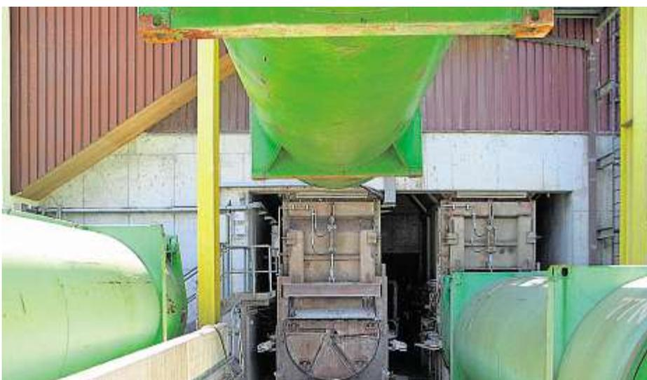
→ In der Müllumladestation: Der Abfall wird von Hydraulikpressen mit etwa 250 Bar Druck in Ferntransportcontainer gedrückt.
