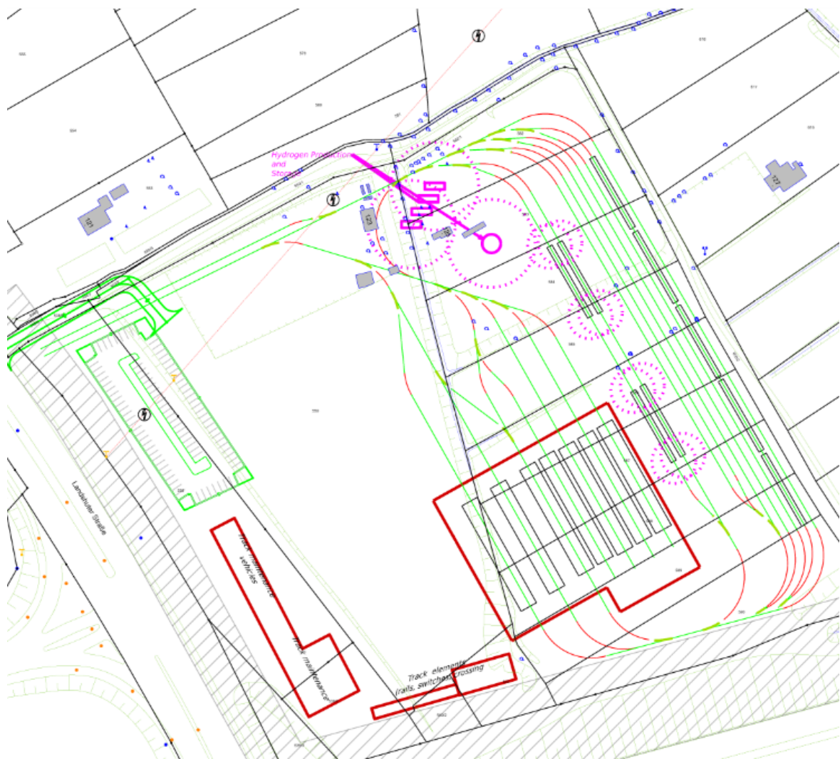
Abbildung 33: Maßstabsgerechter Entwurf für die Betriebshofplanung vom Pürkelgut für Szenario 4 „Wasserstoff“
