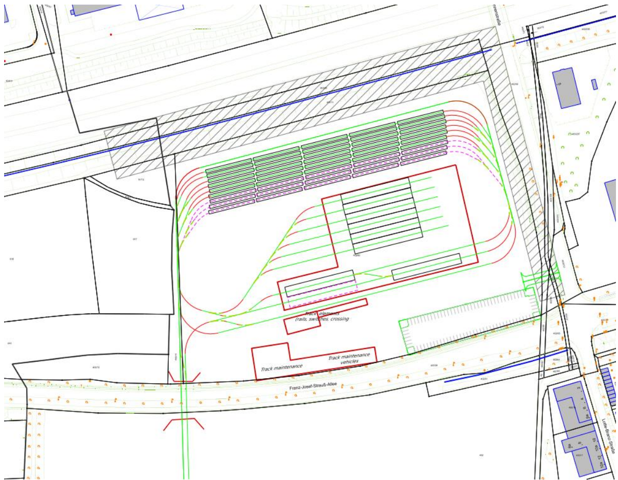
Abbildung 27: Maßstabgerechter Entwurf für die Betriebshofplanung vom Unterislinger Feld für Szenario 1A und Erweiterung 2A (pink)
