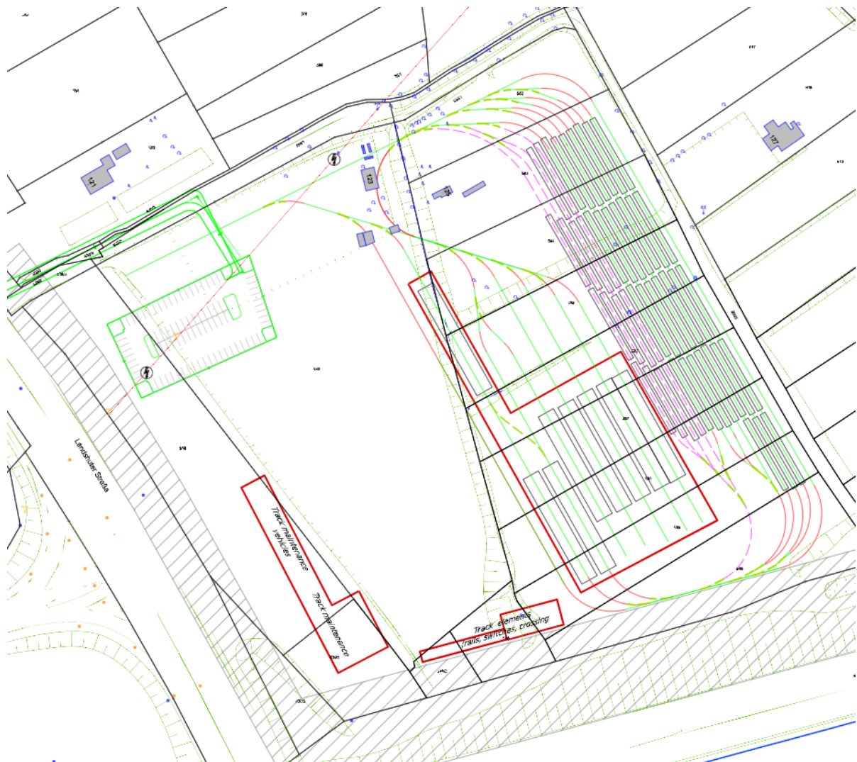
Abbildung 31: Maßstabgerechter Entwurf für die Betriebshofplanung vom Pürkelgut für Szenario 1A und Erweiterung 2A (pink)
