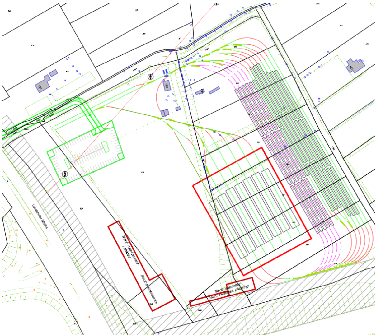
Abbildung 32: Maßstabgerechter Entwurf für die Betriebshofplanung vom Pürkelgut für Szenario 1B und Erweiterung 2B (pink)
