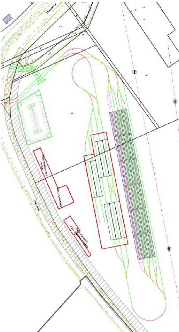
Abbildung 34: Maßstabgerechter Entwurf für die Betriebshofplanung vom Sauerfeld für Szenario 1A und Erweiterung 2A (pink)
