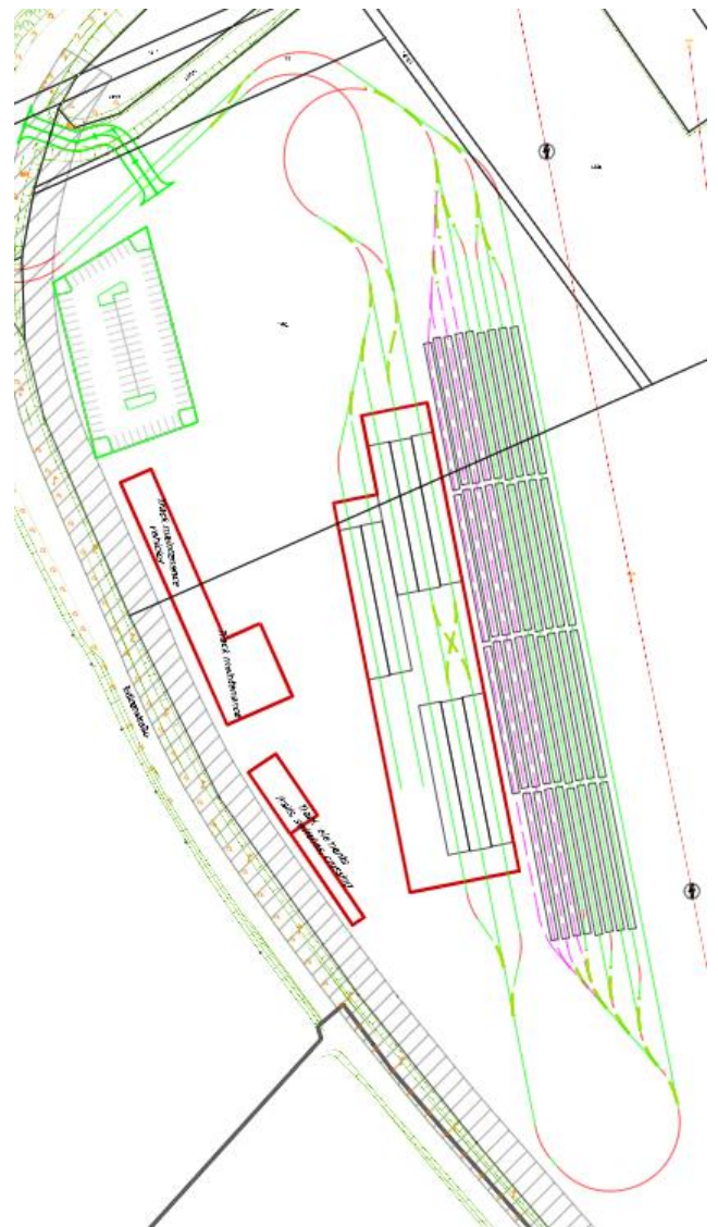
Abbildung 35: Maßstabgerechter Entwurf für die Betriebshofplanung vom Sauerfeld für Szenario 1B und Erweiterung 2B (pink)
