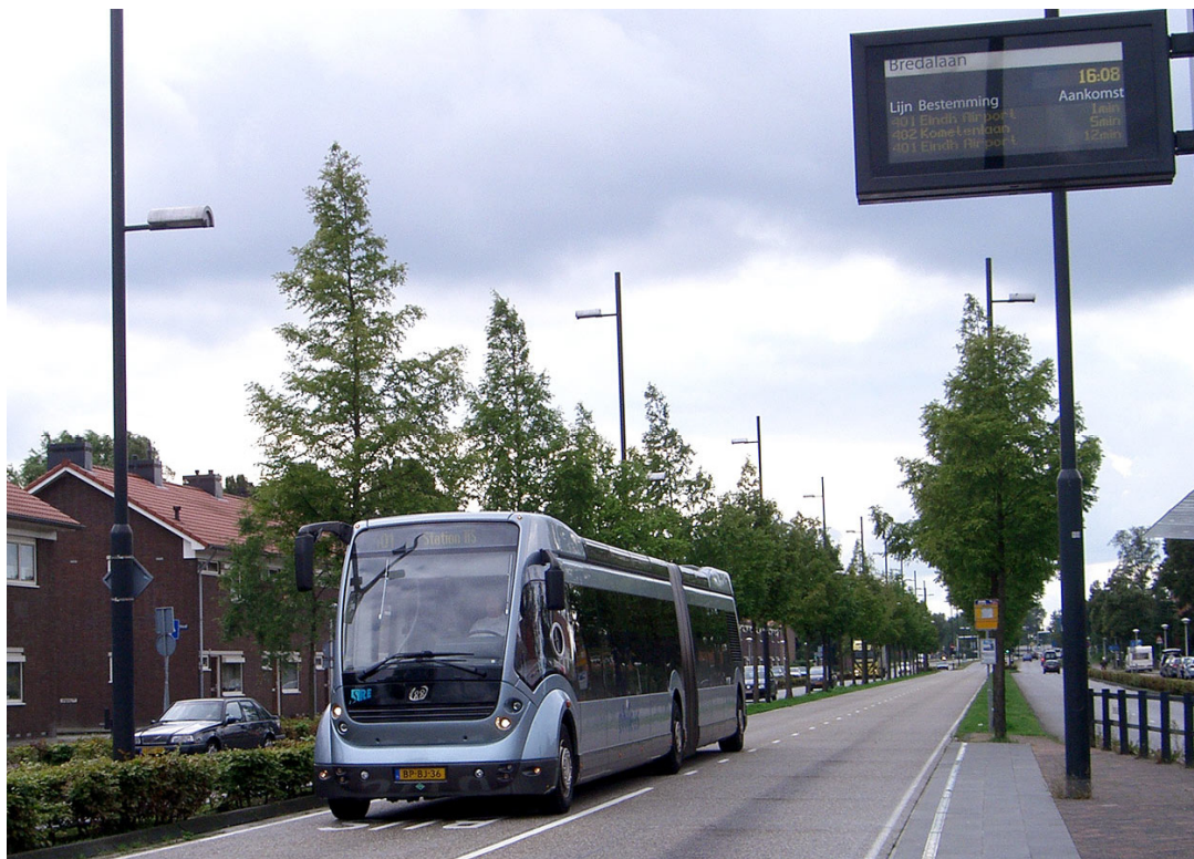
Bild 5: Induktiv über in der Fahrbahn eingelassene Magnete gesteuerter Bus (Beispiel Eindhoven; Quelle: [14])
