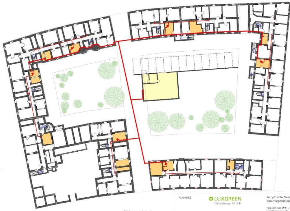
Abbildung 60: Energiezentrale und Wärmeverteilnetz Quartier
