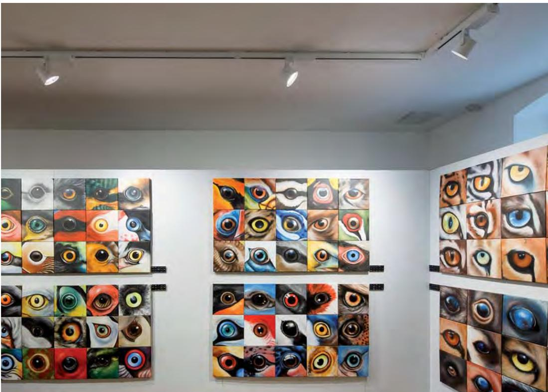
*Naturkundemuseum, Wechselausstellung im Erdgeschoss, Stromschienen mit LED-Strahler, elektrische Leistung 28 Watt, Lichtstrom 2100 Lumen, Lichtfarbtemperatur 3000 Kelvin, einzeln dimmbar, Linse „Wandfluter“*
