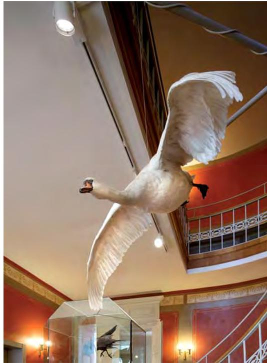
*Naturkundemuseum, Treppenhaus, Tierexponatbeleuchtung, Stromschienen mit LED-Strahler, elektrische Leistung 28 Watt, Lichtstrom 2100 Lumen, Lichtfarbtemperatur 3000 Kelvin, einzeln dimmbar*
