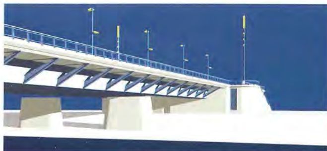
Ansicht Brücke mit Pfeilerpaar, Brückenkopf, Tragwerk mit schrägen Kragarmen, Brüstung und Beleuchtung
