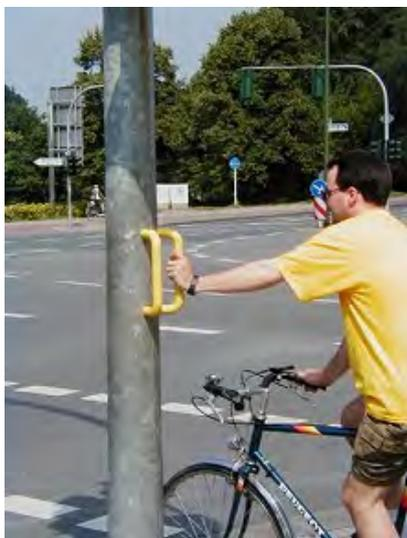
Eine sehr einfache und kostengünstige Maßnahme für eine komfortablere Befahrung von Lichtsignalanlagen ist eine Installation des sog. **Ampelgriffes**. Damit werden an Ampelmasten befestigte Handgriffe bezeichnet, die für Radfahrer gedacht sind, und diesen während der Rotphase eine komfortable Warteposition ermöglichen. Da der Radfahrer im Sattel sitzen bleibt, kann er bei Grün bequemer und schneller anfahren (**Abbildung 27**).
