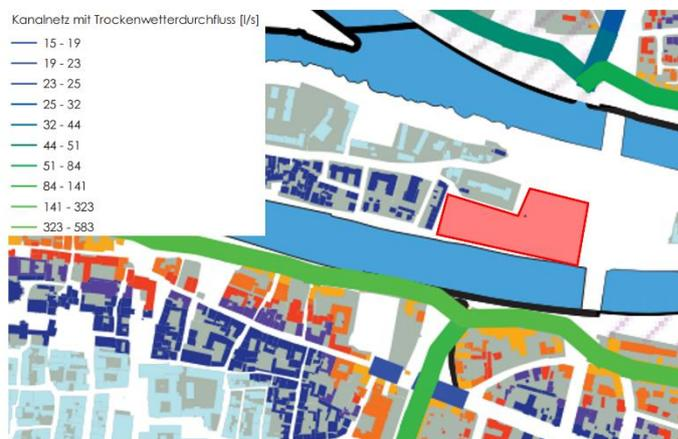
Abbildung 15: Ausschnitt ENP, Potenzielle Abwasserwärmenutzung
