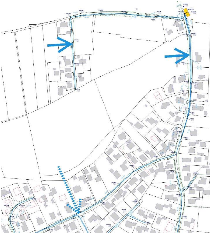
Lageplan mit Kanal und möglichen Anschlussstellen
