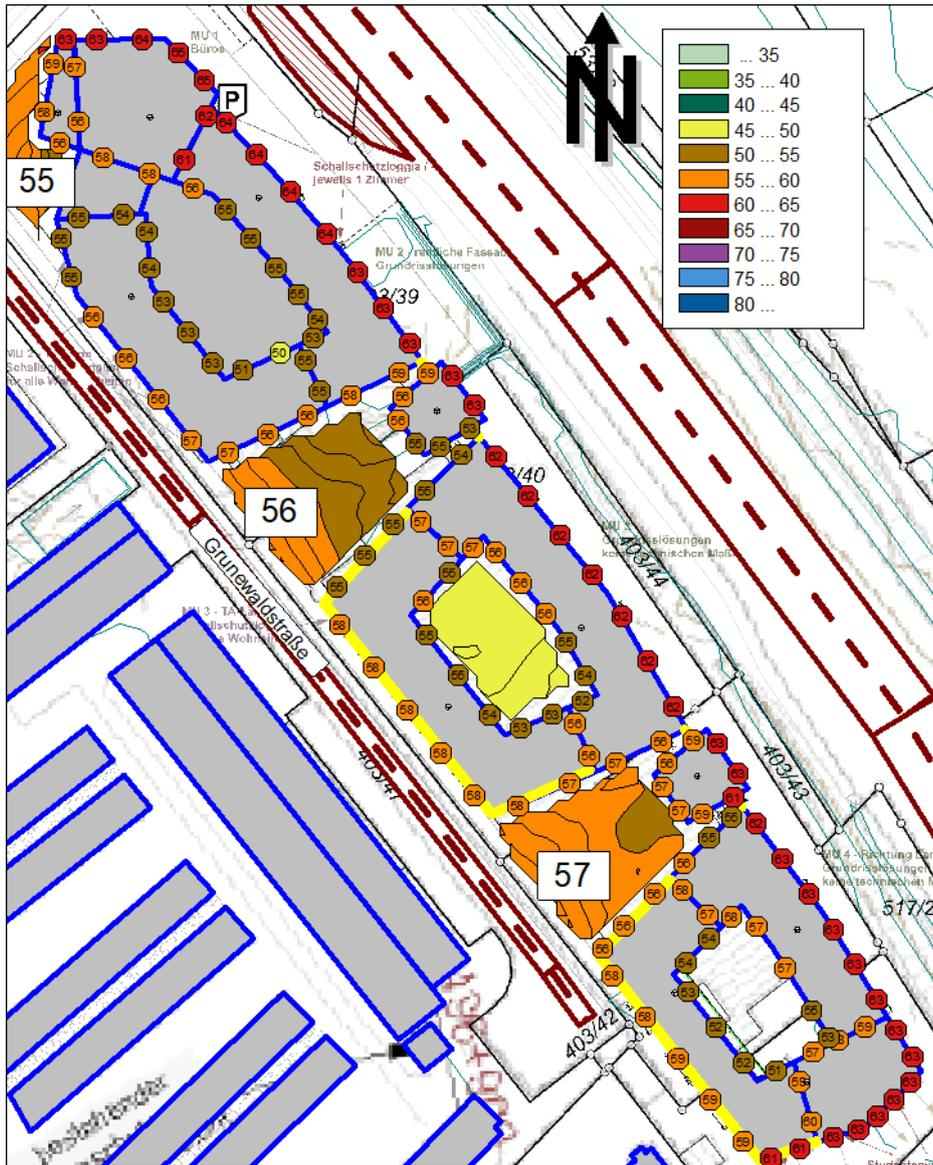
Abbildung 3. Beurteilungspegel Verkehr nachts ( $L_{r, VK, N}$ ) höchster Pegel über Fassade.
