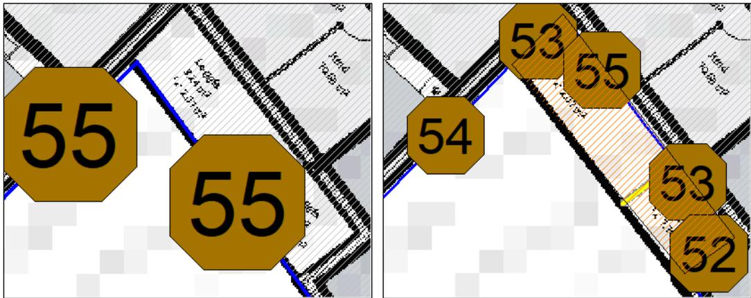
Abbildung 13. Beurteilungspegel Verkehrslärmpegel nachts im Innenhof ohne Maßnahme (links) und mit Loggia inkl. hochabsorbierender Deckenuntersicht.
