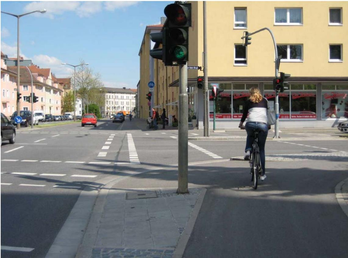
Abbildung 9: Furtmayrstr. / Hermann-Geib-Str.: Keine separate Radfahrersignalisierung
