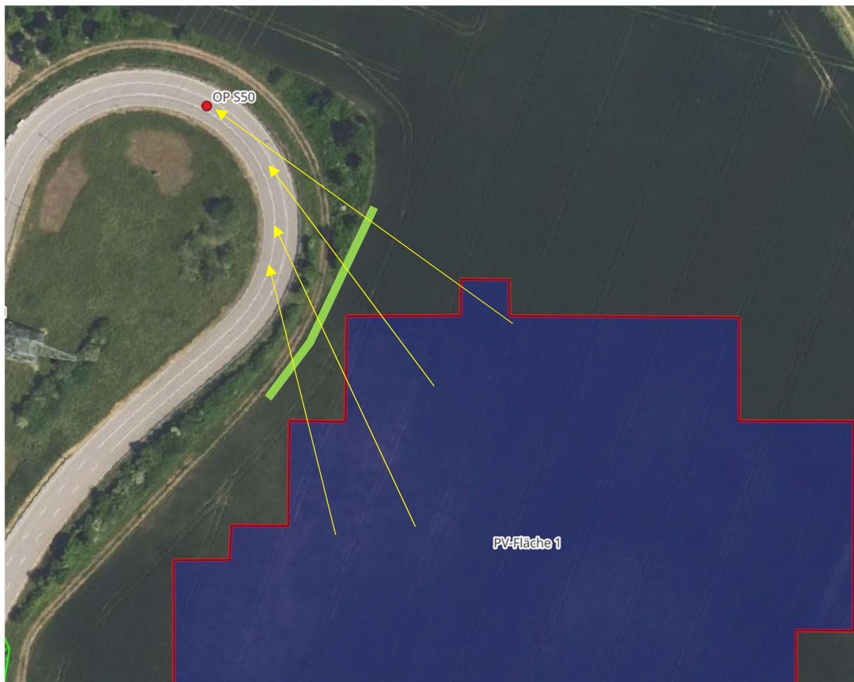
Abbildung 20: Skizze der störenden Reflexionen in den nördlichen Kurvenbereich (gelbe Pfeile) sowie empfohlene Position eines zusätzlichen Sichtschutzes (grün)
