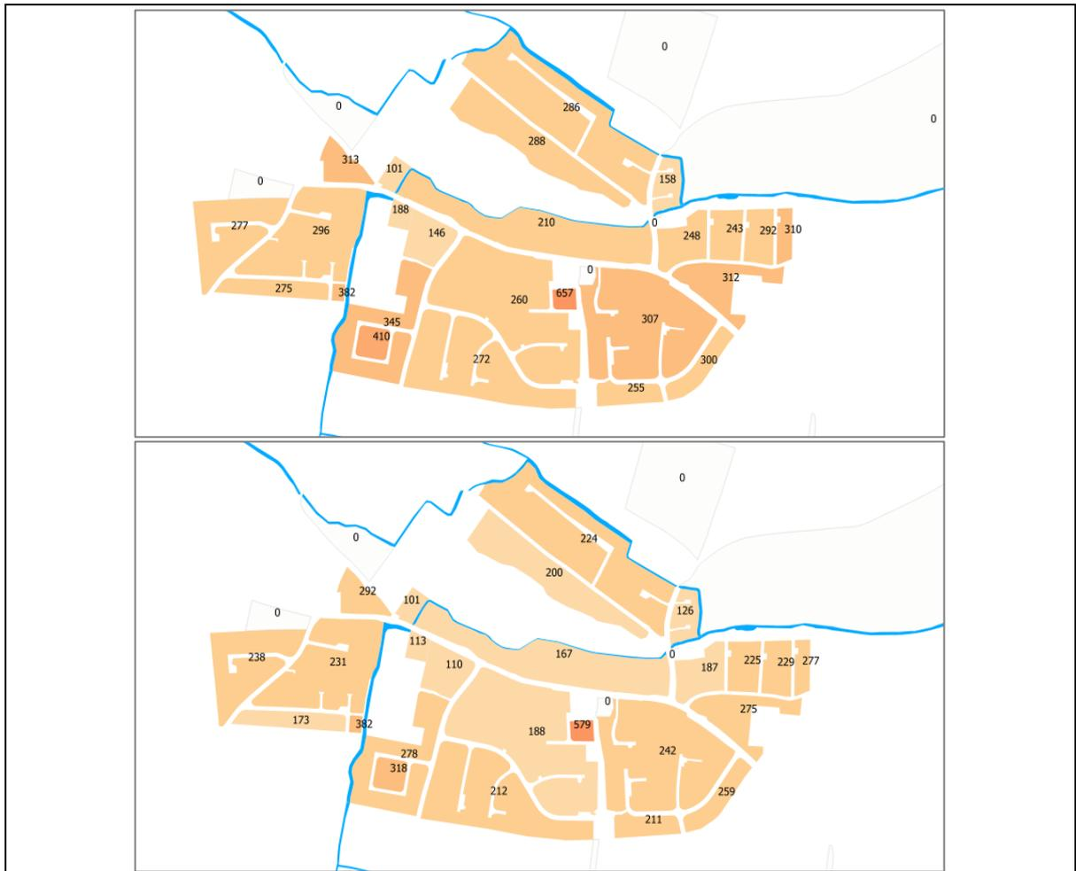
**Abbildung 43: Wärmebedarfsdichten in Megawattstunden pro Hektar und Jahr in Harting für 2012 und für 2030 im Klimaschutzscenario**
