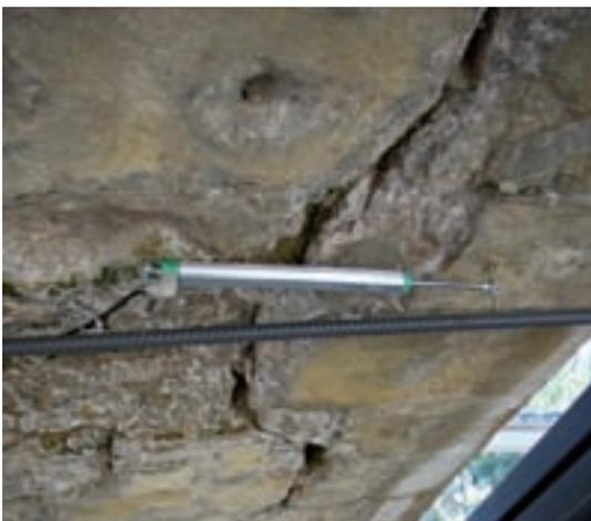
Abbildung 23: Rissüberwachung (Monitoring) zur Bauwerkssicherung
