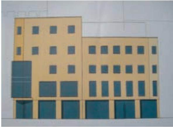
Abbildung 2: Erstentwurf mit geplanter Aufstockung und Erkerbildung
