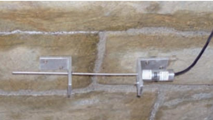
Die Ergebnisse am Bogen IX zeigten, dass - was zu erwarten war - die Rissentwicklung auch durch die Instandsetzung des Bogens nicht zum Stillstand kommt und ständig Bewegungen aufgrund der Temperaturschwankungen entstehen. Relativ zur Nullmessung sind temperaturbedingte Rissbreitenänderungen von -0,41 mm (Risssschließung) bis +1,96 mm (Rissaufweitung) aufgetreten.
