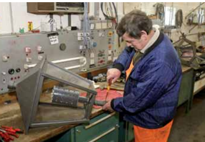
Einsetzen der LED-Retrofits und Montage und Funktionskontrolle vor Ort
