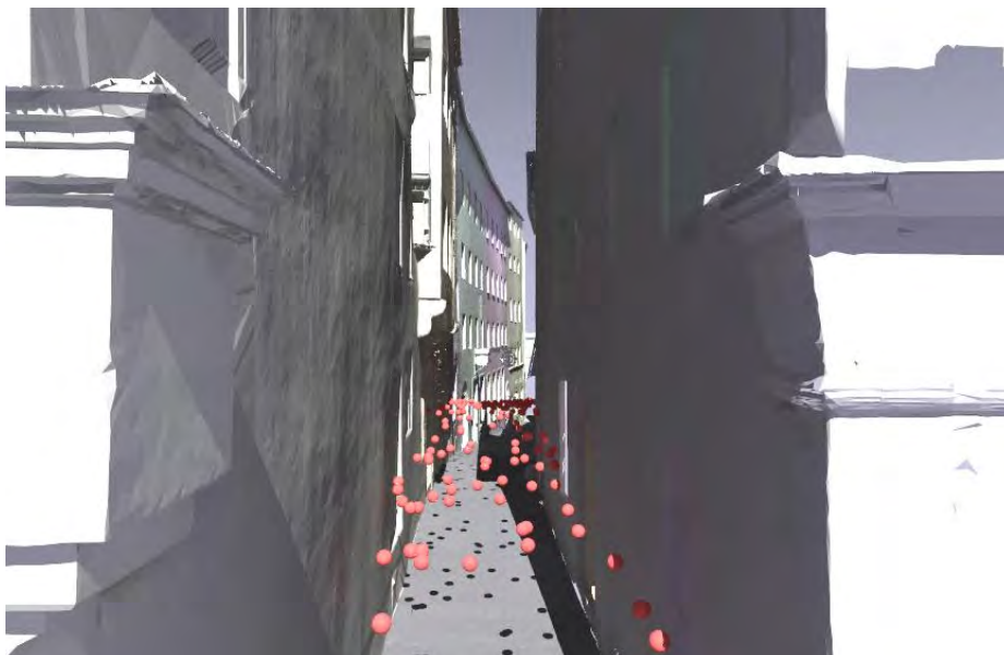
Simulation zur Berechnung der Beleuchtungsstärke (Grundlage Laserscanning)
