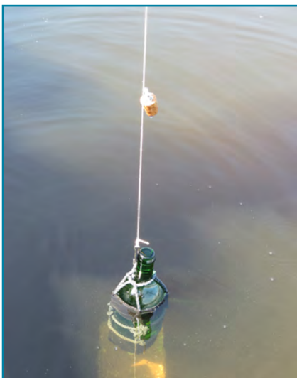
Wenn keine Luftblasen mehr aufsteigen, wird die Flasche vorsichtig nach oben gezogen.
