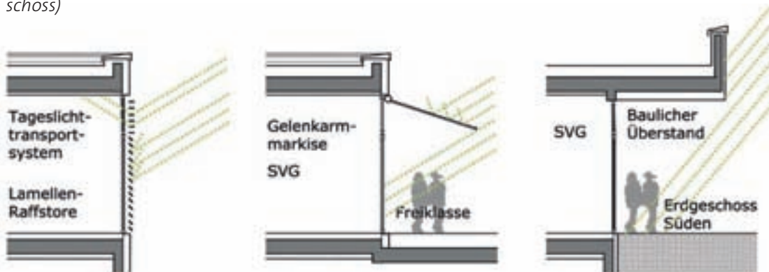
Abbildung 7: An die jeweilige Fassade angepasste Sonnenschutzsysteme
