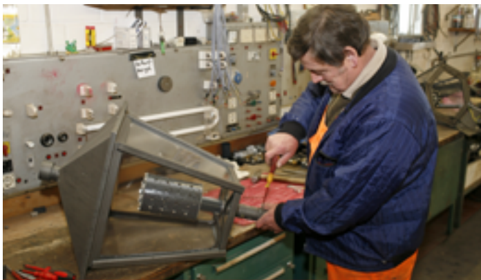
Abb. 23: Umrüsten einer Altstadtleuchte auf LED mit einem OSRAM Retrofit
